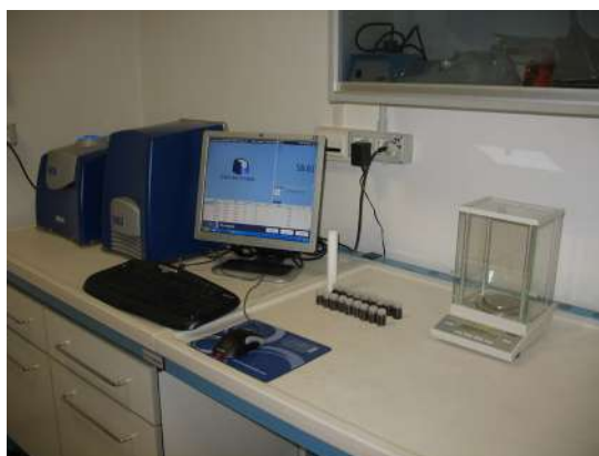
Foto 3.4. Determinazione del contenuto in olio nella polpa mediante risonanza magnetica nucleare (NMR) presso i laboratori del DiSAAA-a.
