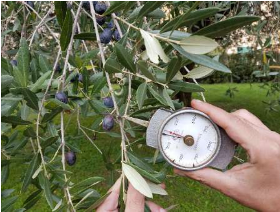
Foto 3.10. Dinamometro utilizzato per la misura della forza di distacco del frutto.
