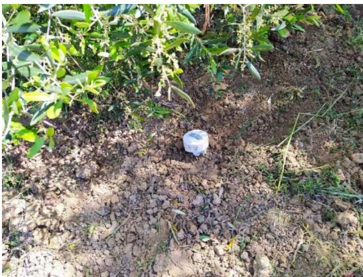
Figura 3- Sensore BFS-40 Elmed Srl per il rilevamento dell'umidità del suolo a profondità di 10, 30 e 50 cm installato in azienda
