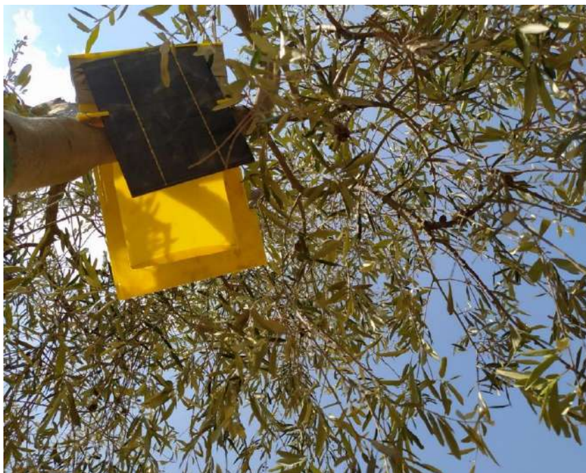
Figura 4- Trappola automatica EYE-TRAP per il rilevamento degli attacchi parassitari in oliveto
