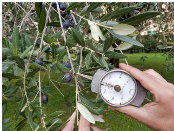
Foto 10. Dinamometro utilizzato per la misura della forza di distacco del frutto.
