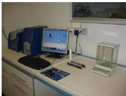
Foto 4. Determinazione del contenuto in olio nella polpa mediante risonanza magnetica nucleare (NMR) presso i laboratori del DiSAAA-a.
